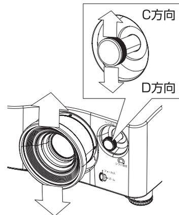
3) シフトレバーを図の方向に回して固定する
