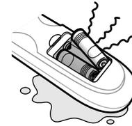
間違えますと電池の破裂、液もれにより、火災・けがや周囲を汚損する原因となることがあります。
