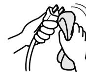
湿気などで絶縁不良になり火災・感電の原因となります。電源プラグを抜き、乾いた布でふいてください。
