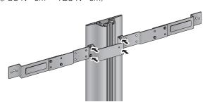
⑤ 壁寄せスタンド用取付金具の穴と本機後面の突起部(位置決めピン)を合わせ、 壁掛け金具固定用ねじ(2本)(付属)で固定する
