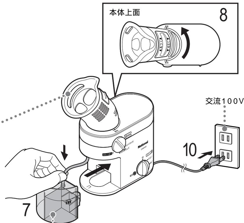
チューブが折れないように指で持ち、給排水カップ(給水側)の中へ入れてから、本体にセットする チューブは無理に引っ張らない。
