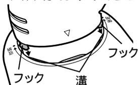
図のように、吸入ノズルのフック2ヶ所を、吸入アタッチメントの溝に合せて奥まで挿入し、吸入ノズルを回転させてください。
