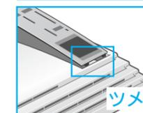
よこ用表示パネルのツメと反対側の突起部を前面カバーの穴に軽く押し込んでください。
