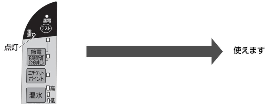
■本体の電源ランプが消灯している場合は、電源プラグを差し直してください。
