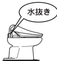
凍結すると、配管や本体内部が破損して水漏れの原因となります。
