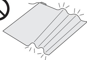
内部のヒーターを傷め、火災・感電の原因になります。
