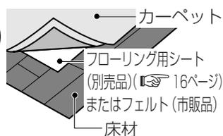
断熱をしないと、床材の変色・変形・割れ・すき間の原因になります。
