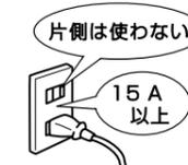
他の機器と併用すると、発熱による火災の原因になります。
