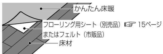
断熱をしないと、床材の変色・変形・割れ・すき間の原因になります。
