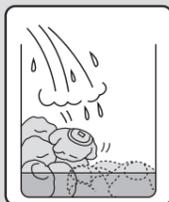
給水を行い、布の片寄りを自動修正します。表示は脱水からすすぎに戻ります。その後、「速乾き脱水」(約1時間)をはじめから行います。
