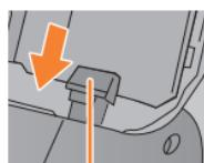
矢印の方向に動かしてロックを外して取り出す
