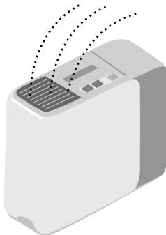
水を含んだ加湿フィルターから湿気が出るとき、空気中の熱を奪うため、室温より低い温度の風が出ます。
