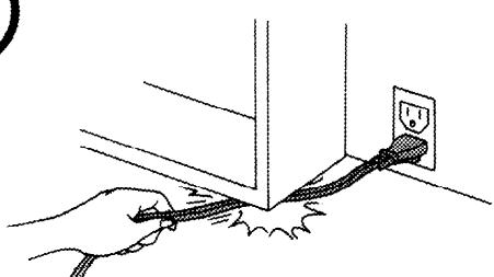
電源コードが破損し、火災や感電の恐れがあります。
