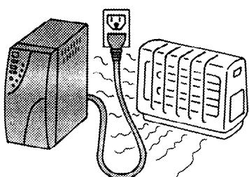
本機の内部温度が上昇して、蓄電池の中の液漏れ、部品の劣化、電源コードの被ふくが溶けて、火災や感電の恐れがあります。
