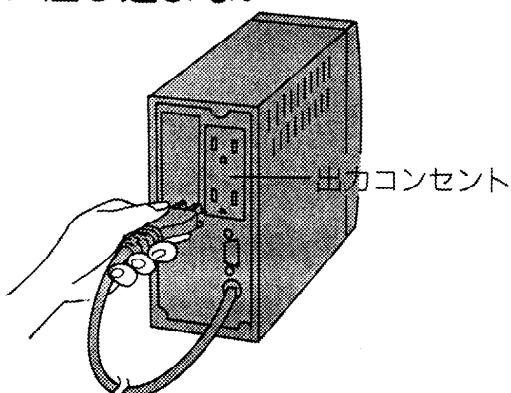
本機を使用中に入力プラグを出力コンセントに差込むと異常電流が流れ火花が発生し、やけど、視覚障害の恐れがあります。
