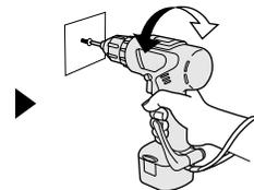
スイッチを切って、正逆切替スイッチを中央で止めてスイッチロックの位置にし
